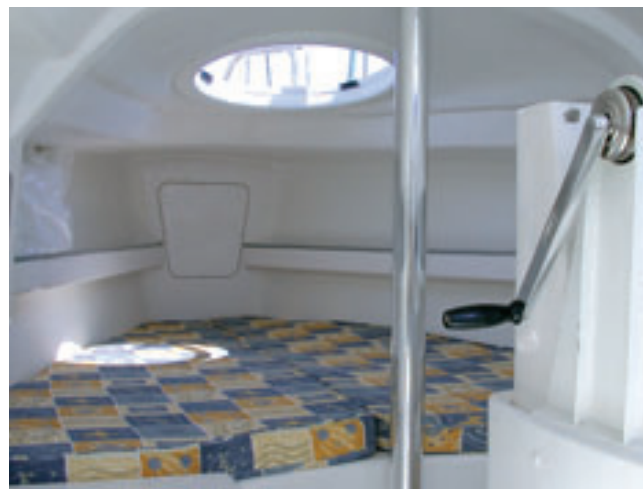
Cabine O içamento da quilha — feito através de engrenagem acionada por manivela — é funcional
